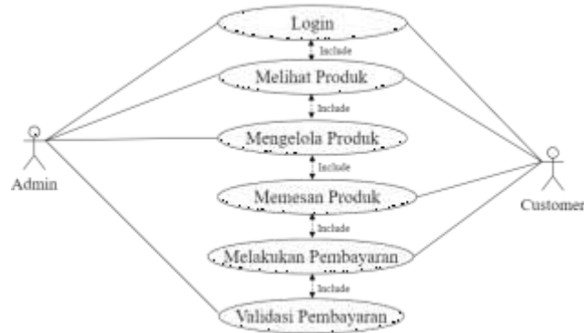
Gambar 4. Use case sistem usulan
